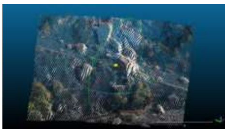
Αποτύπωση βραχοπτώσεων με TLS (Μύλοι Ηλείας 2019)
