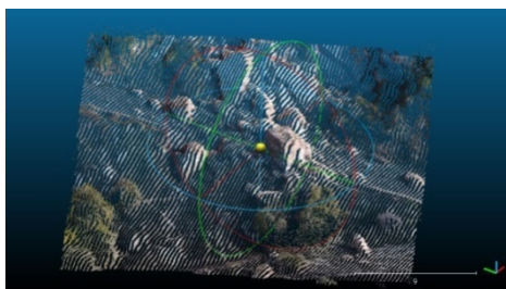
Αποτύπωση βραχοπτώσεων με TLS (Μύλοι Ηλείας 2019)
