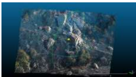
Αποτύπωση βραχοπτώσεων με TLS (Μύλοι Ηλείας 2019)
