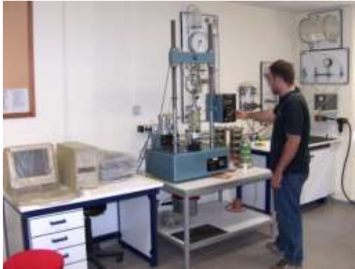
Συσκευή τριαξονικής φόρτισης για εδάφη
