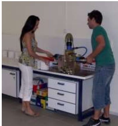
Συσκευή διάτμησης ασυνεχειών βράχων
