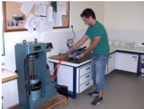
Συσκευή τριαξονικής φόρτισης για βράχους
